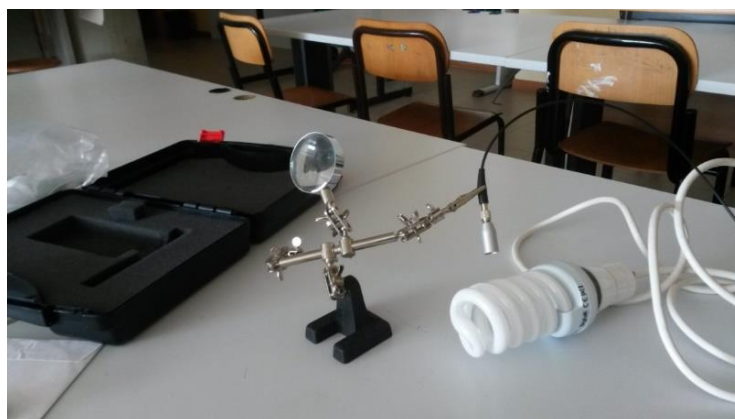
Fig. 16 Configurazione sperimentale della fibra ottica e della lampada
