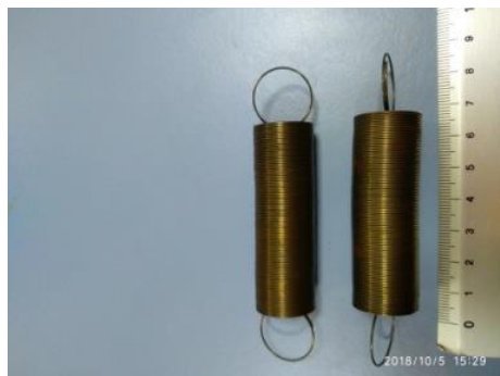
Due molle identiche di costante elastica k = (4,5 \pm 0,5) \text{ N/m}
